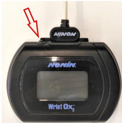
Figure 11 Bouton d'alimentation de l'oxymètre de pouls
